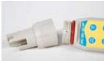
El sensor incluye sondas para pH y para conductividad/TDS/salinidad
